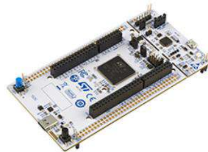
Slika 1. Razvojno okruženje STM32 nucleo H755ZI-Q.
