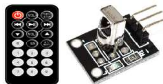
Slika 2. Izgled IC daljinskog upravljača i prijemnika HX1838.
