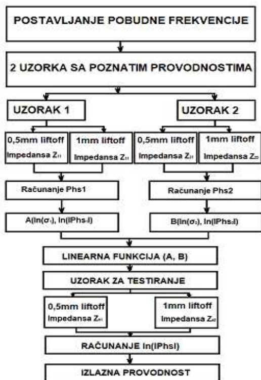
Slika 2. Algoritam beskontaktnog merenja provodnosti [1].
