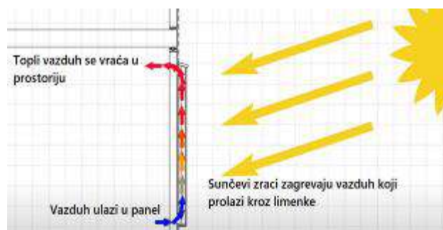
Slika 3. Princip rada solarnog kolektora.
