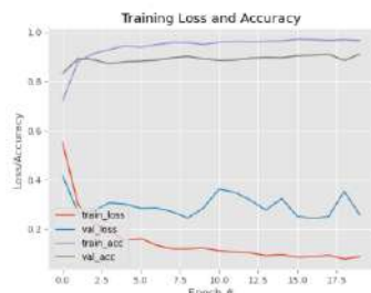
Slika 6. Preciznost i greška tokom treniranja neuronske mreže za prepoznavanje da li osoba nosi masku.
