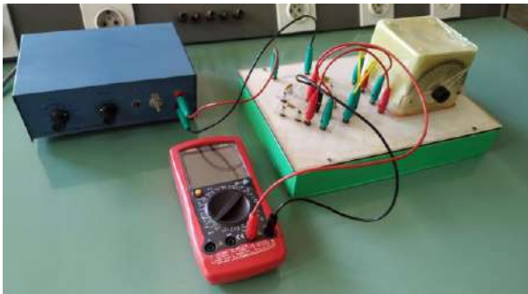
Slika 5. Vinov most za merenje nepoznate kapacitivnosti.
