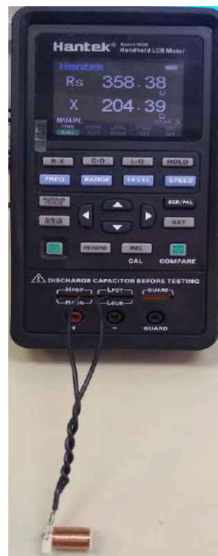
Slika 4. Instrument za merenje parametara impedanse kalema Hantek 1833C.
