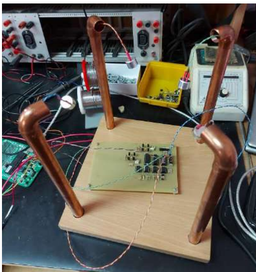
Slika 2. Fizička realizacija sistema, na slici se vide konstrukcija anemometra sa primopredajnicima van krakova anemometra i raster ploča sa zalemljenim komponentama (sredina) i ReadyForPic okruženje (levo).
