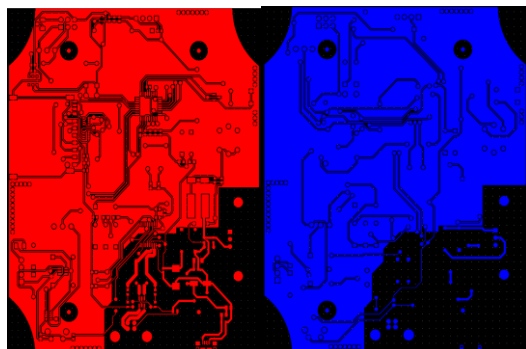
Slika 23. Prikaz gerber fajla za gornji deo (levo), odnosno donji deo štampane ploče (desno).
