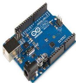
Slika 2. Arduino okruženje sa mikrokontrolerom AT mega 328P.
