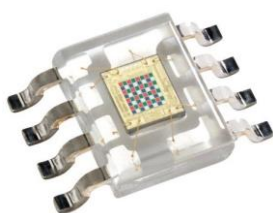
Slika 5. Izgled TCS3200 senzora za određivanje boje i raspored njegovih pinova.
