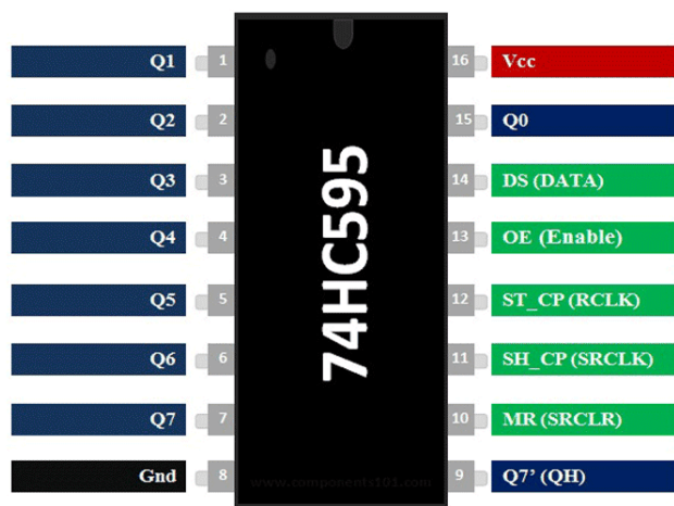
Slika 2. Šema pinova šift registra tipa 74HC595 [5].
