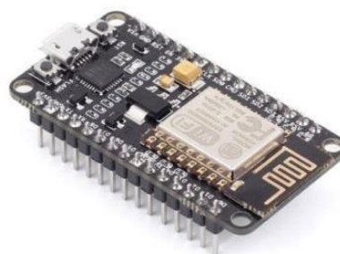
Slika 2. Korišćeno okruženje ESP12-E sa Wi-Fi modulom.
