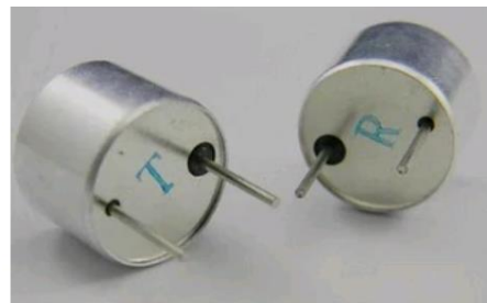
Slika 2. Cilindrični transdjuseri (u tekstu „cilindri“) koji su deo svakog od UZ modula.
