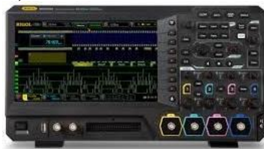
Slika 7. Korišćeni logički analizator RIGOL MSO5000.
