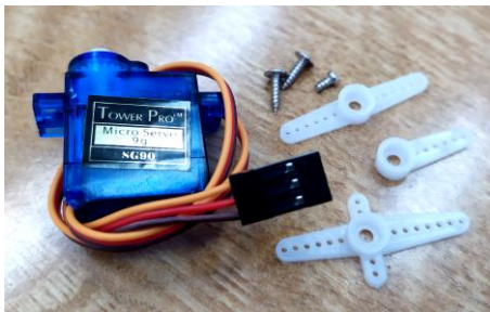
Slika 2. Izgled Tower Pro SG90 servo motora, nastavaka i dodatnih montažnih elemenata.
