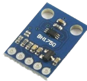
Slika 4. Fizički izgled senzora BH1750.
