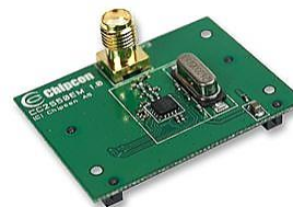
Slika 1. Izgled CC2500EMK primopredajnog modula bez antene.
