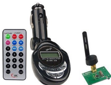
Slika 2. FM radio predajnik i primopredajni modul sa CC2500.
