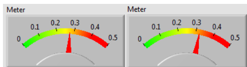
Slika 11. Vrednost napona na izlazu senzora na nižoj (levo) i višoj (desno) temperaturi.
