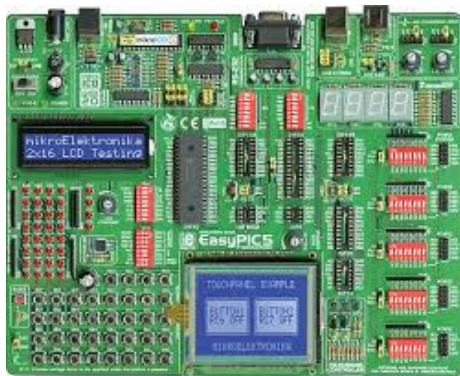
Slika 7. Razvojno okruženje mikroElektronika EasyPIC v5 .
