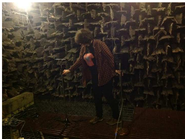
Slika 10. Postavka laboratorijskih vežbi u anehoičnoj prostoriji
