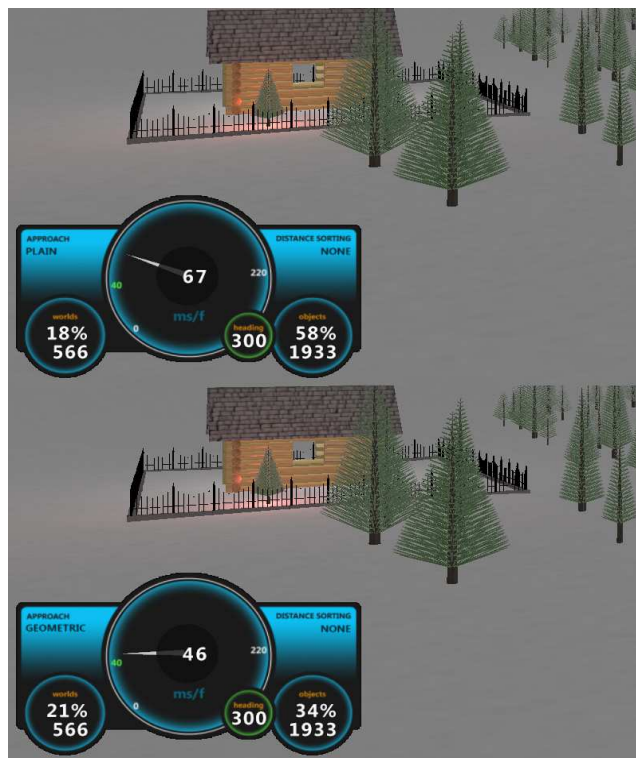
Slika 3. Brzina iscrtavanja frejmova bez (gore) i korišćenjem (dole) view frustum culling metode.
