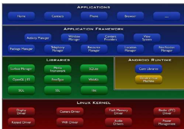
Slika 2. Arhitektura android sistema
