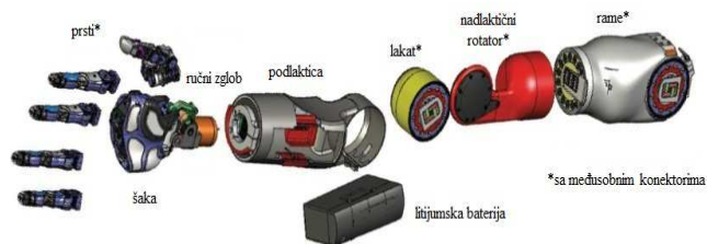
Slika 2. Prikaz pojedinačnih elemenata bioničke ruke [2]
