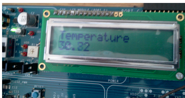
Slika 5. Izmerena temperatura prikazana na LCD displeju
