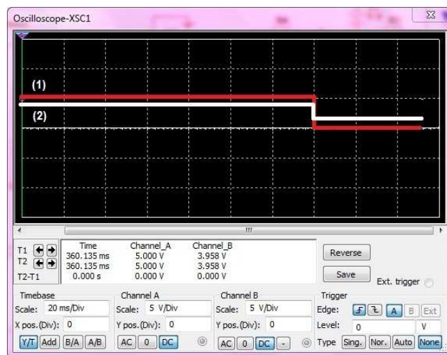
Slika 6. Rezultati dobijeni pri naponu na optokapleru od 5 V.
