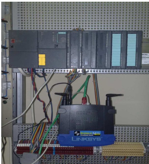
Slika 1. Laboratorijski panel sa SIEMENS PLC-om i Wireless ruterom.
